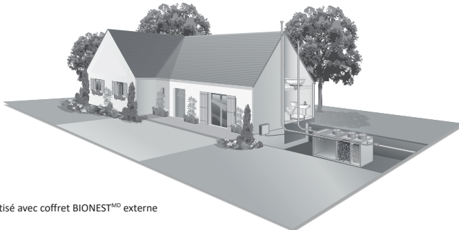
FIGURE 1-2 : VUE EN COUPE - MODÈLE DE LA SÉRIE UNIK RELIÉ À LA MAISON 2
